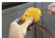
2. Załóż śruby oczkowe oraz napinacz linki.
